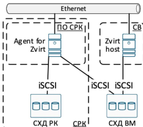
Рисунок 2. Функциональная схема СРК.
