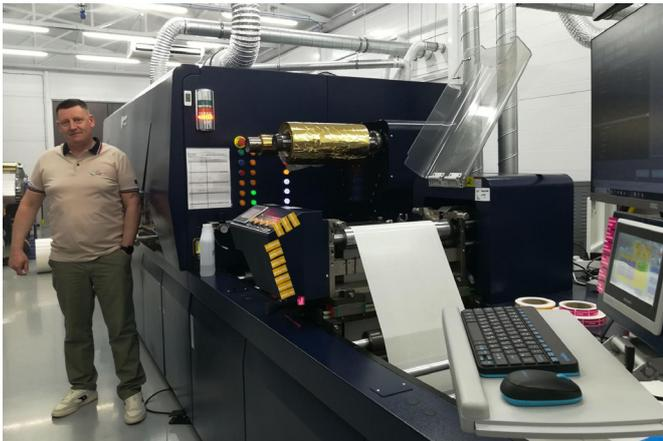
Последнее приобретение типографии «Санрайз» — китайская цифровая печатная машина Aobead Pulisi DPIM-330F-II с модулем для тиснения фольгой. Под это оборудование пришлось строить отдельное помещение с климат-контролем. На фото Дмитрий Акатов
